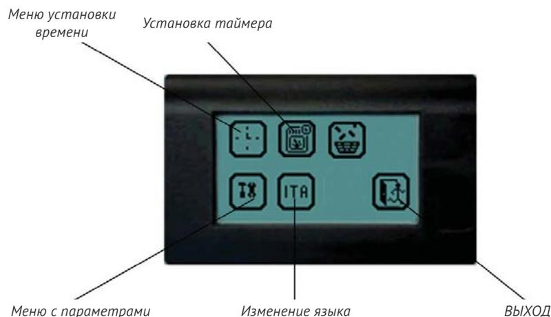
В данном меню пользователь устанавливает точное время, по желанию таймер и выбирает желаемый язык для отображения сообщений на экране устройства. Уполномоченный технический специалист может в данном экране войти в режим настройки параметров. Вход защищен паролем.
