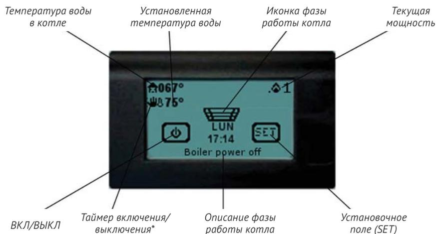
\* если в верхнем левом углу отображается ладонь, то котел находится в ручном режиме работы, таймер котла выключен. Если в этом месте отображаются часы, значит, таймер включен. Если изображение часов мигает, это означает, что таймер активирован.
