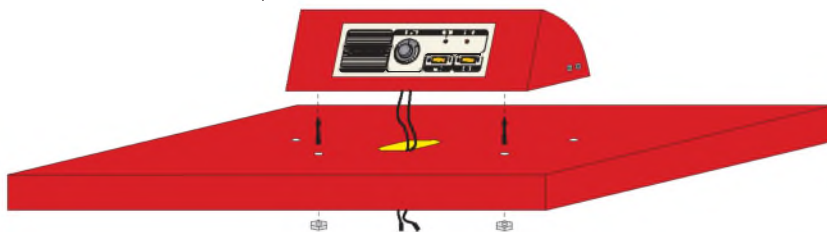
Рис. 5.1. Монтаж панели управления на котел
